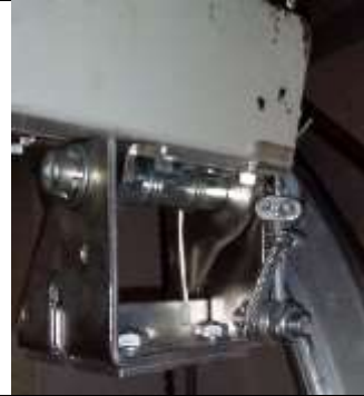
13. Крепление троса к устройству защиты от обрыва троса
